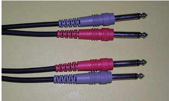
Fig : Cordon double pour réaliser une connexion stéréo
