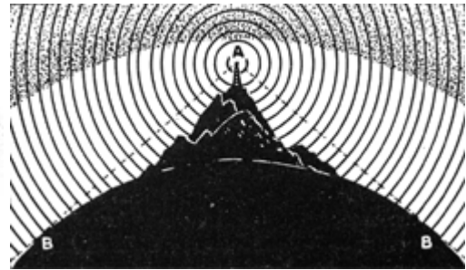
Figure 4 Notez la grande distance qui se trouve maintenant comprise entre les deux B. Le poste émetteur étant placé au sommet d'une montagne, un bien plus grand nombre d'ondes touchent la terre. Plus l'antenne est haute, plus les ondes à fréquence modulée couvrent de milles à la surface de notre planète.
